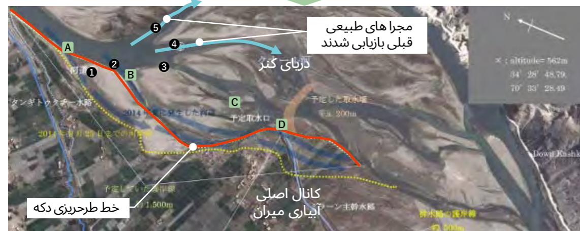
شکل: فرسایش ساحل دریا و اقدامات متقابل در دروازه آبیگر در میران 4
