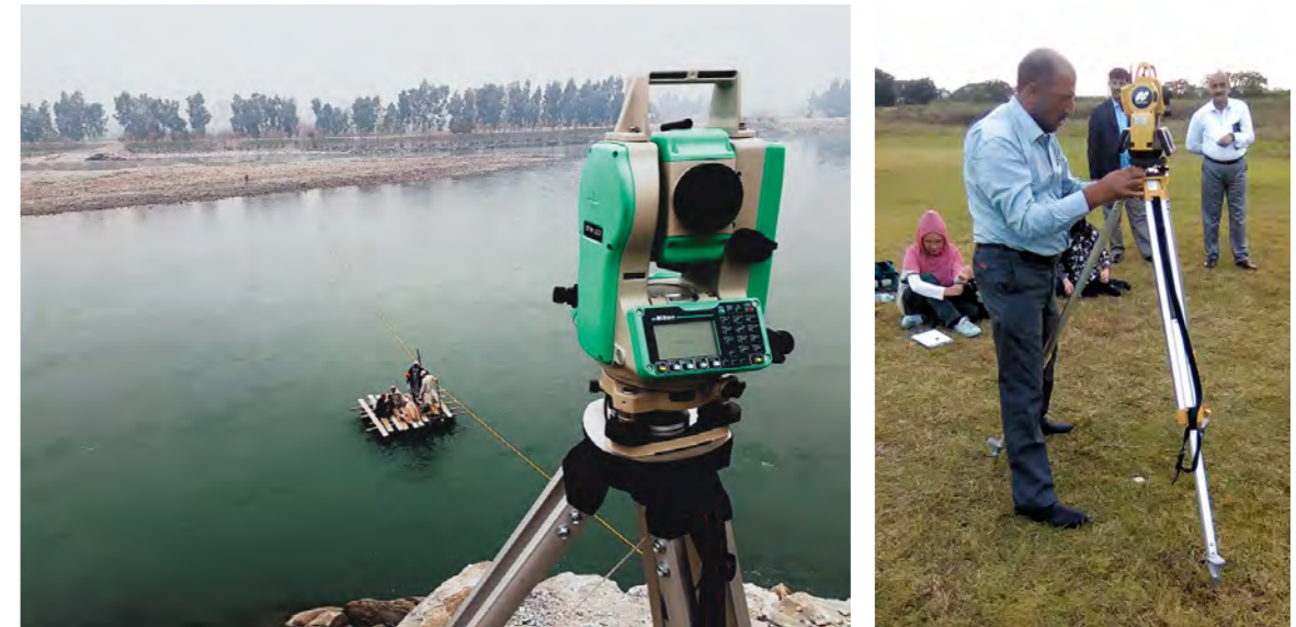
تصویر 3.7: سروی و بررسی دریا با استفاده از Total Station 12
