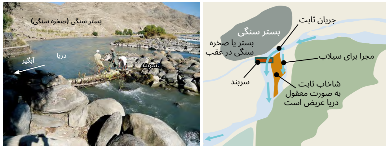
شکل 4: سایت مناسب برای سربند سنگی مایل در پروژه آبیاری روش PMS
