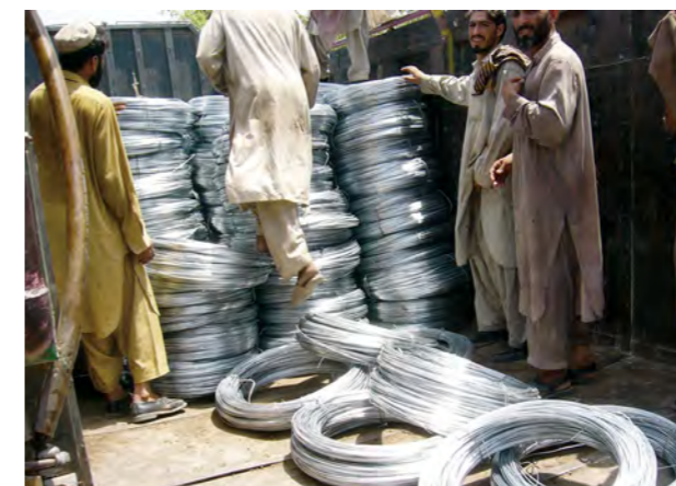
تصویر 4.10: سیم های سخت و محکم (حرارت دیده شده) و آب فلز خورده (3)
