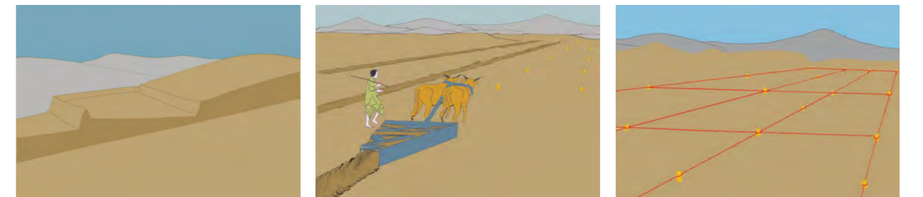
شکل 8.2: روش ساخت آبیاری غیر کنترولی (طرح کلی) (1) تنظیم ساحه آبیاری (2) شکل‌گیری پلوان‌ها (ایجاد) (3) تسطیح سطح خاک هر دسته
