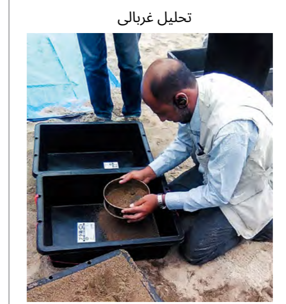
شکل 3.18: سروی و بررسی مواد بستر دریا ۱۲
