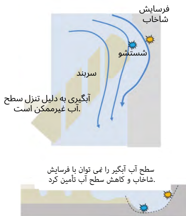
شکل 4.16 : شستشوی بخش های متصل سرپند سنگی مایل به سواحل دریا / شاخاب 13
