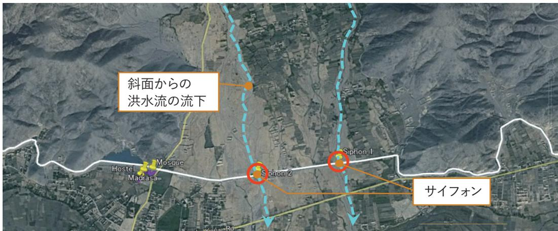
図4.50 洪水流下区間におけるサイフォンの設置<sup>2)</sup>
