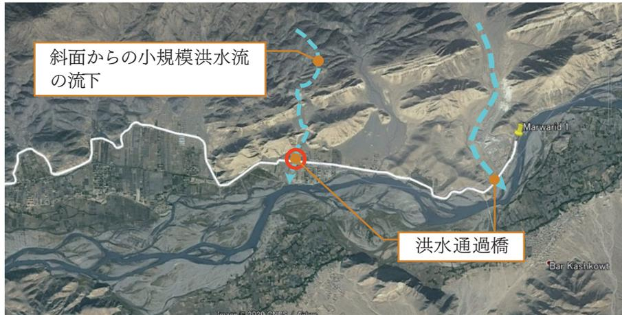
図4.53 洪水流下位置における洪水通過橋の設置<sup>2)</sup>
