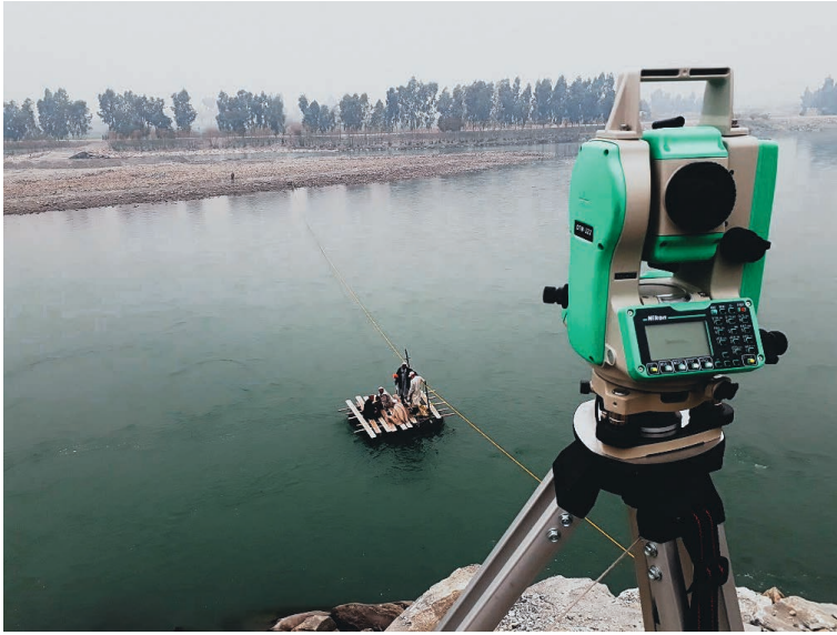
写真 3.7 トータルステーションによる河川測量 2)
