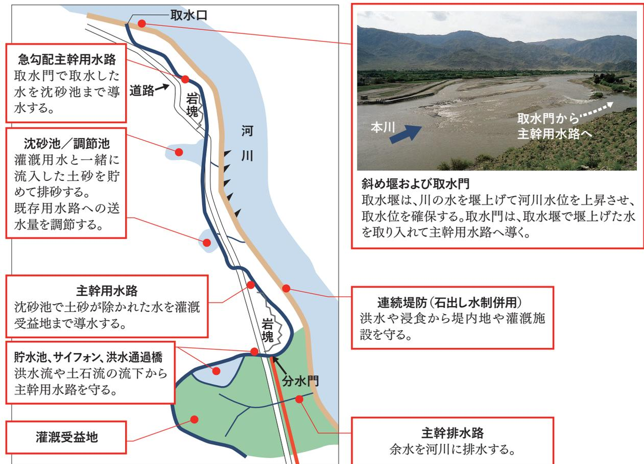
図1.3 PMS方式灌漑システムを構成する主な構造物<sup>2)</sup>
