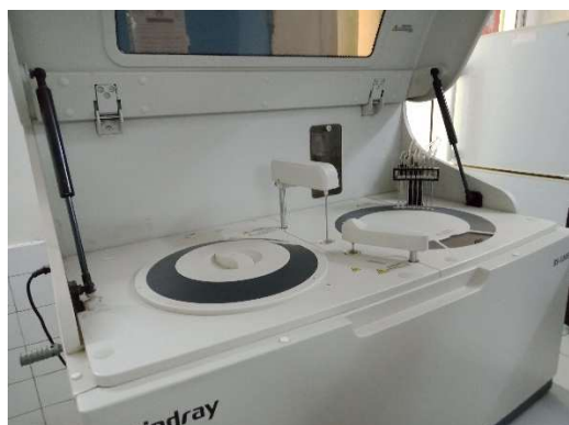
生化学分析装置(検査室) 現在稼働中ではあるものの、部分的に故障している。更新が必要な時期となっている。
