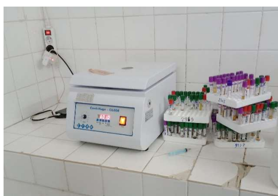
遠心分離器 (検査室) 現在稼働中ではあるものの、更新が必要な時期となっている。
