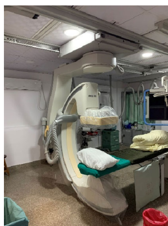
写真 12 病院本棟に設置されている C アーム。
