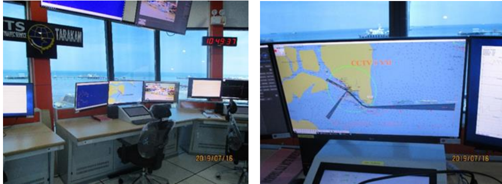
Gambar 4.1.6 -1 : Ruang Operasional VTS, Konsol AIS
