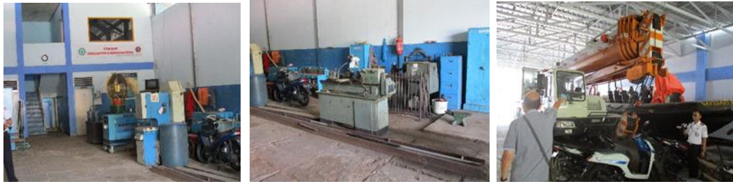
Gambar 4.1.13 -3 : Mesin Las, Mesin bubut, Kendaraan Crane
