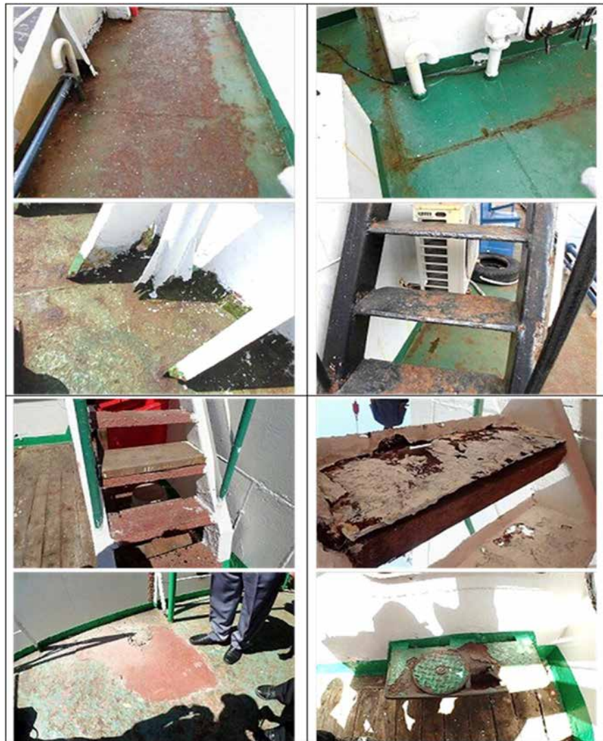
第 6.8.4 -2 写真 設標船の床面及びステップ状態
