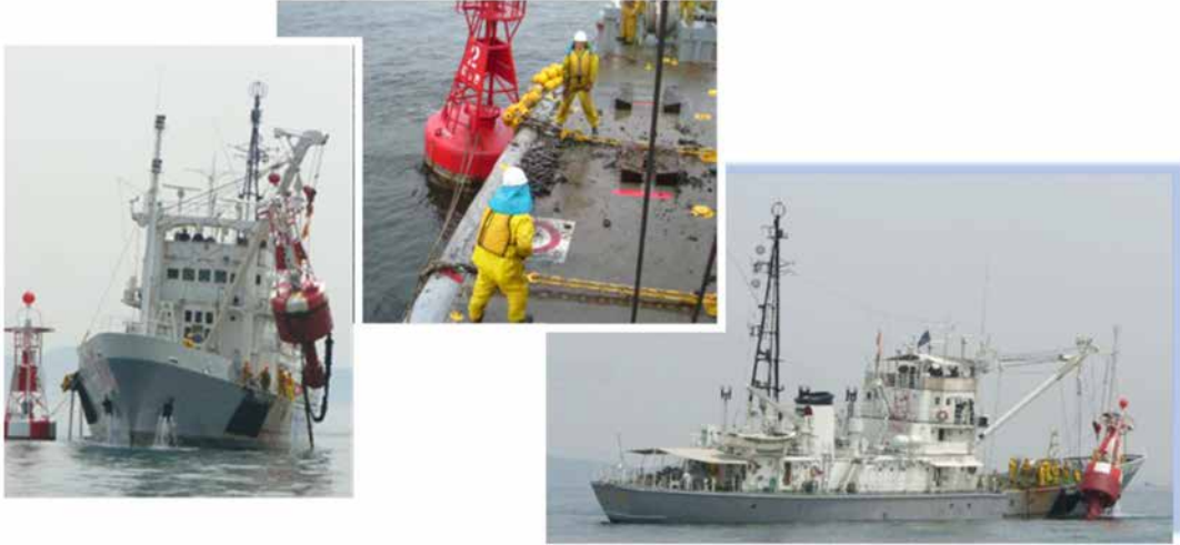
第 6.7 -3 写真 灯浮標交換の様子 (参考例)
