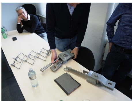
ステンレス鋼棒と板を曲げる際の抵抗を活用したブレーキシステム。
