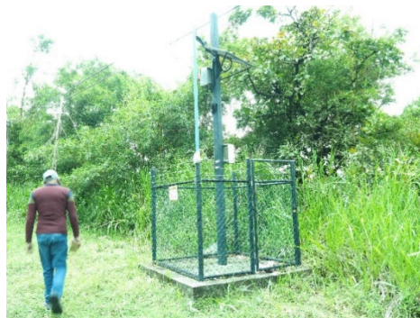
図 5-15 スリランカの国道沿いの地すべり地に設置された雨量観測(左)と通報装置(右)
