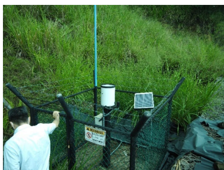
図 5-15 スリランカの国道沿いの地すべり地に設置された雨量観測(左)と通報装置(右)
