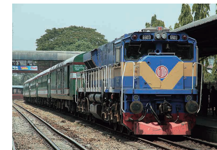
ダッカ市内にあるバングラデシュ国鉄駅。軌間は1000mmおよび1676mmを使用、構内は三線軌条。
