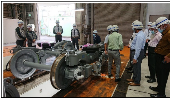
写真 39:台車の保守作業状況の視察
