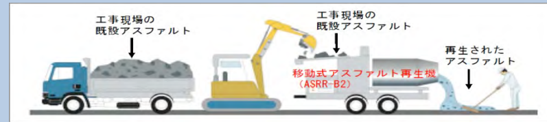
移動式アスファルト再生機(ASRR-B2)
