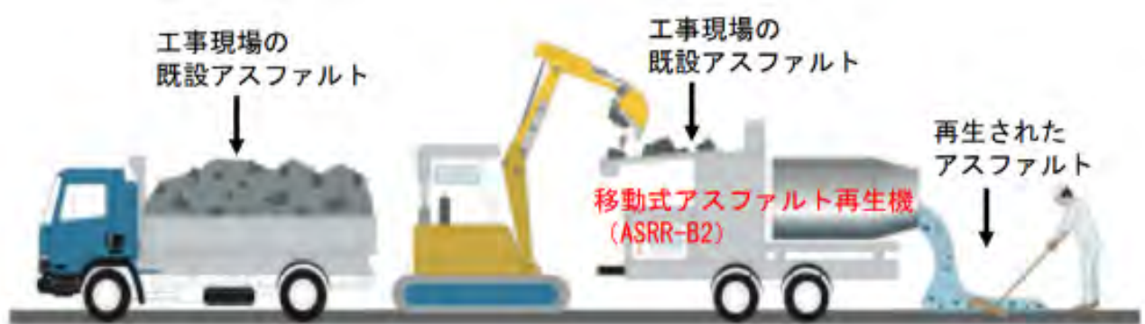
図 5 移動式アスファルト再生機(ASRR-B2)を活用した表層再生工(ASRR 工法) (提案法人作成)
