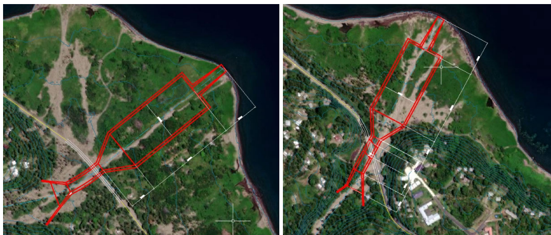
図 1.1.9 計画配置図（左：Ranguna 橋梁エリア、右：Karavi 橋梁エリア）
