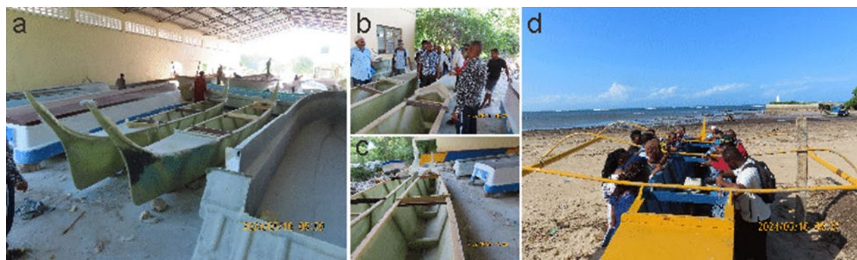
図 48. 第 3 回国内研修で紹介された、製作中の FRP 製バンカ船の船体（a）、ケニア人製作者 Pwani 社による説明（b）、フィリピン人技術者が第 2 回国内研修時に製作した木造バンカ船について説明しているところ
