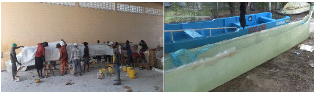
図 45. バンカ船のモルド製作のために FRP 生地を木製バンカ船に張り付けているところ (左)、取り出した FRP 製のバンカ船船体 (右)
