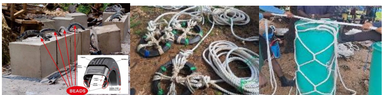
図 53. タイヤビードをロープ取り付け部に使ったコンクリートアンカーブロック（左）、タイヤビードをロープ連結部に使った係留ロープ枠（中）、中古 PE ドラムを使った 200L 大型浮子（右）
