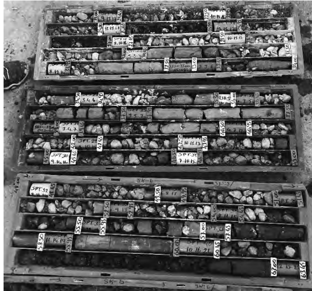
図3-79 平野のボーリング調査結果（アンタキヤ）
