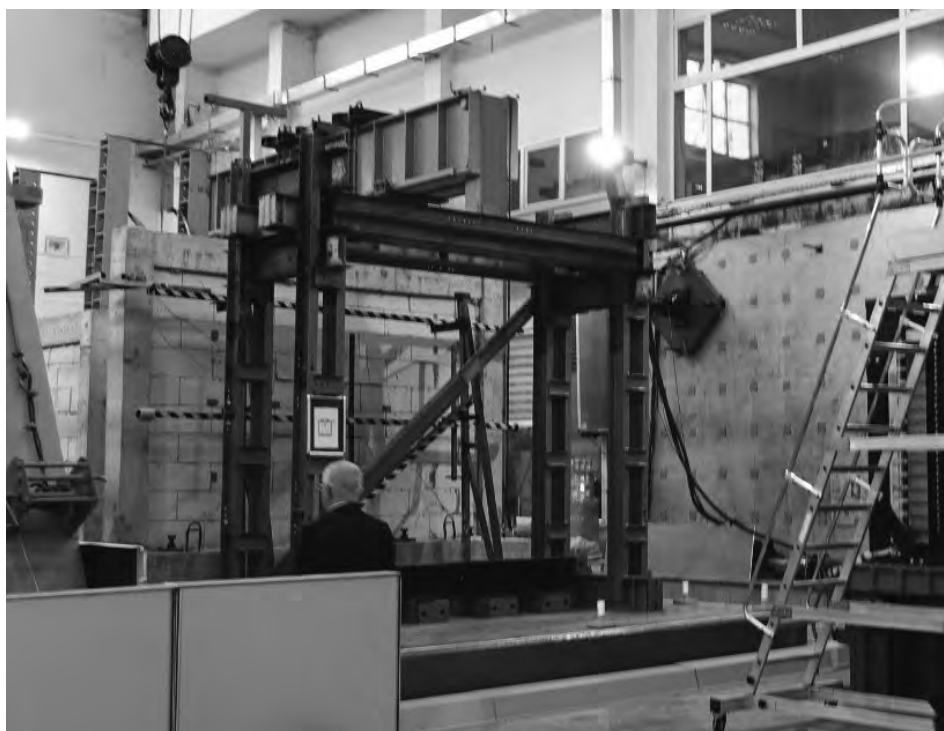
図3-2 反力壁と反力床を用いた载荷装置
