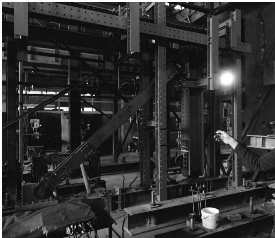
図 3-3 反力壁と反力床を用いた載荷装置
