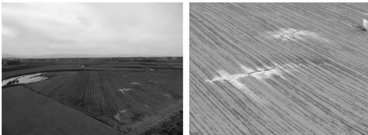
図3-57 周辺地盤で見られた地盤変状（トーマ橋）
