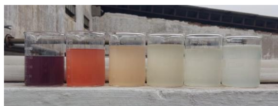
FB 投入による排水の色の変化
