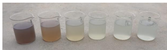
FB 投入による排水の色の変化
