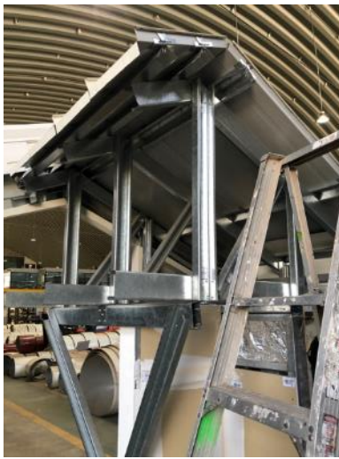
ボリビアに多い金属の屋根構造模型
