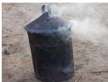
図 6-45 小型ドラム缶を使った雛形の燻製窯
