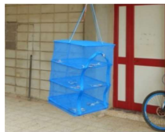
図 6-44 吊り下げ式ネット型乾燥器
