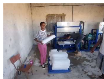
図 6-62 製氷機の試運転、一度に 30 個の製氷が可能
