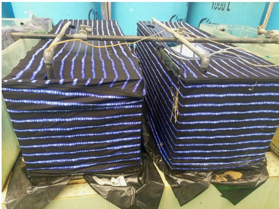
Figure 3: Aquarium muni d'un système de recirculation en eau de mer, couvert par d'un tissu sombre utilisé pour l'expérimentation
