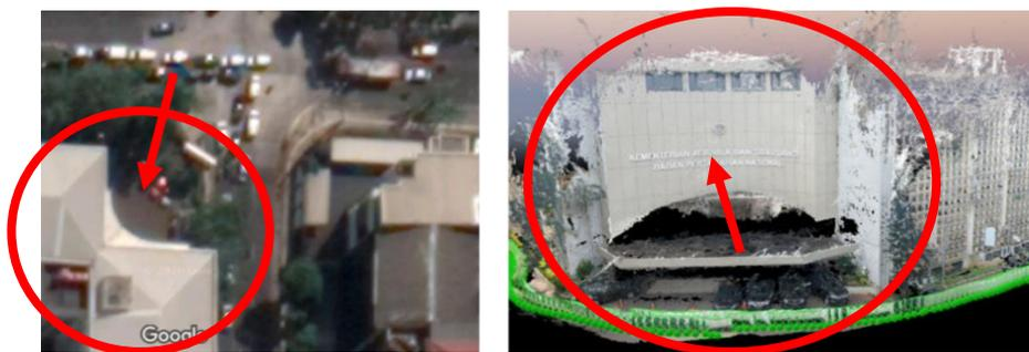
図 2.17 上空からの衛星画像（左）と 3D 計測データ（右）の違い
