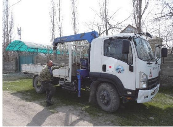
クレーン付きトラック (路面補修機材運搬)
