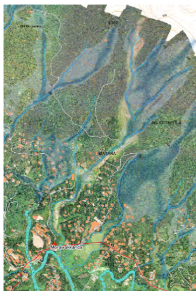
図 2.14: Morawakkanda における検証結果の例 背景写真：土石流到達範囲の空撮画像 青グラデーション：土石流危険区域抽出範囲
