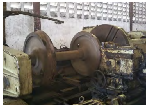
図 4-42 Limete 輪軸工場 車輪削正
