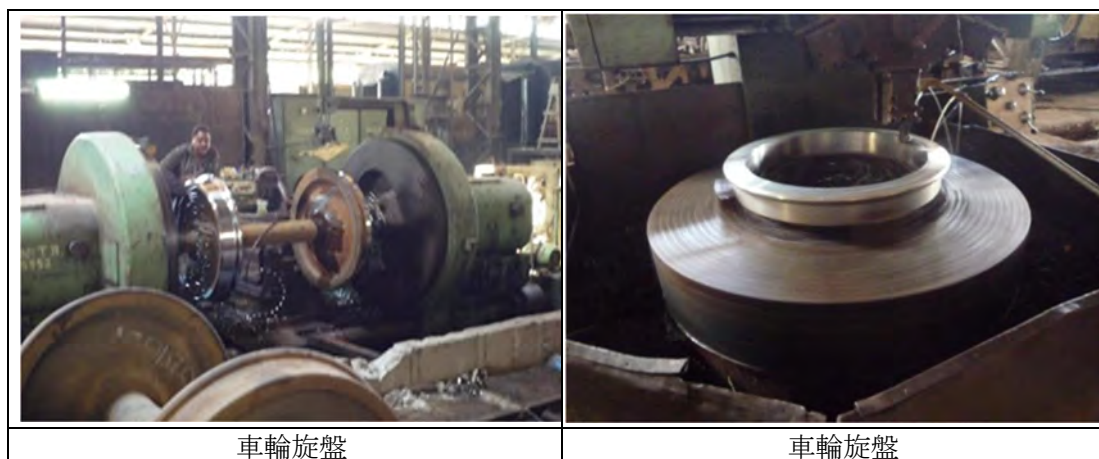
図 2-23 車両工場内の車輪旋盤
