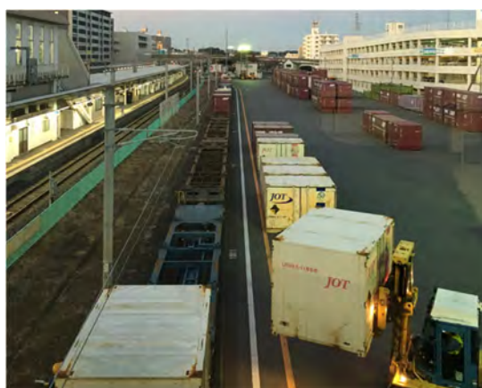
図 7-131 コンテナホームでコンテナの積み下ろしを行うフォークリフト
