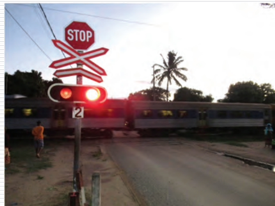
踏切警報灯の作動状況
