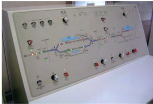
図 3-43 閉そく装置イメージ（駅装置）
