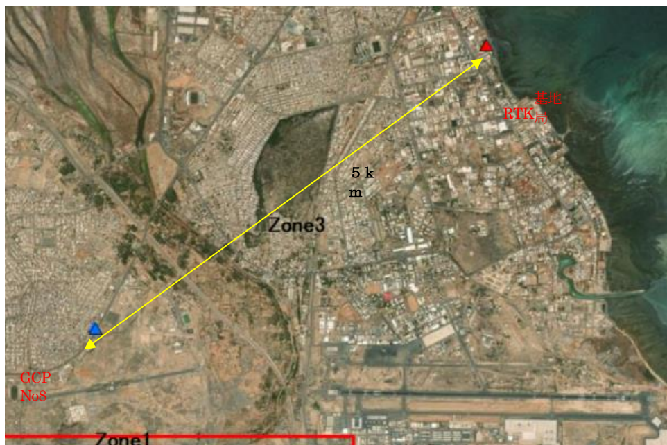
Figure 4-37 Relation de position entre la station de base RTK le point géodésique national No8
