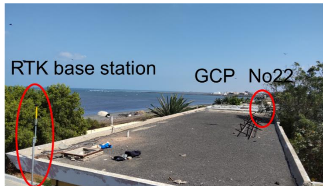
Figure 4-36 Station de base RTK et le point géodésique national No22
