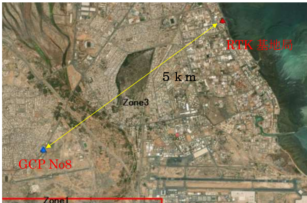
図 4-37 RTK 基地局と国家基準点 No. 8 の位置関係
