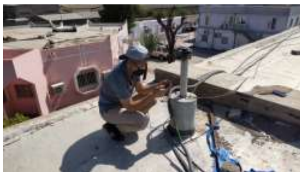
国家基準点での GNSS 受信機の検証
