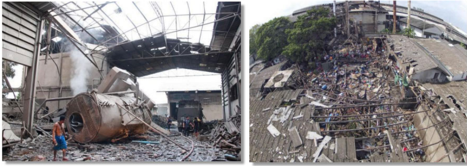
図 5.18 バングラデシュにおける近年のボイラ爆発事例
