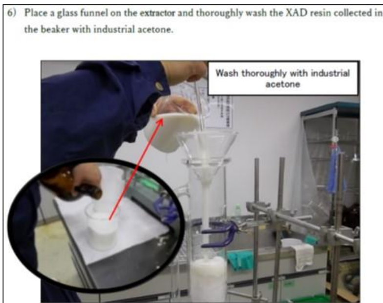
図 2.24 作成された技術資料の例 - 排ガス用の捕集材(XAD 樹脂)の洗浄準備
