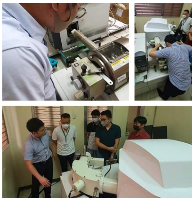
図 2.23 GC/HRMS 製造会社技術者による GC/HRMS のトランスファーライン修理の状況
