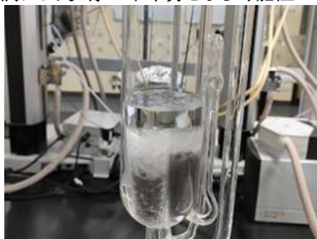
図 2.33 PUF の膨潤により洗浄が不十分となる可能性がある例(赤い線より上)
