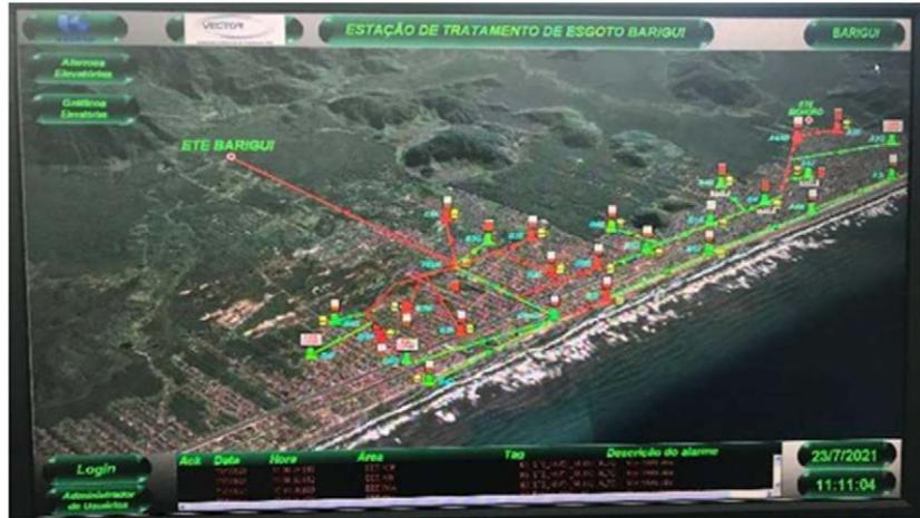
※(例)Barigui 処理場における SCADA の監視画面。処理区内にある全てのポンプ場の運転状況を一覧できる。画面の切替によって個別のポンプ場の運転状況を確認でき、一部のポンプ場に対してはポンプの遠隔制御も行える
