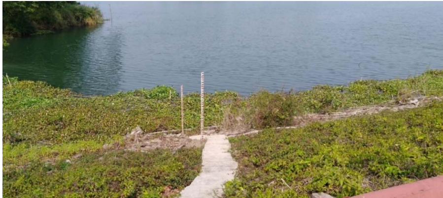
図 4.2.2 カプタイダム水位計の設置状況
