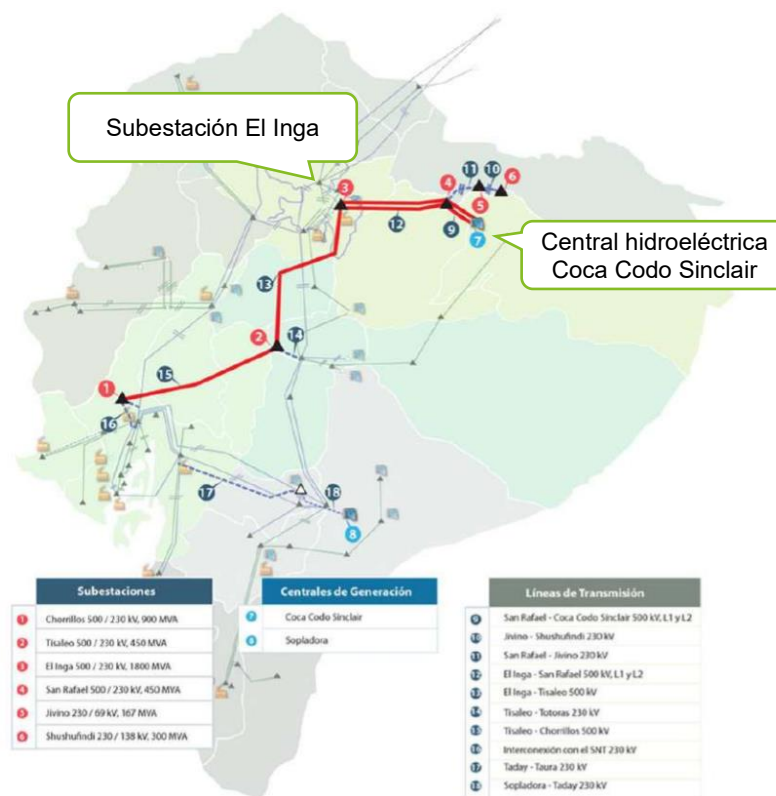
Figura 6-9 Central hidroeléctrica Coca Codo Sinclair y la línea de transmisión de 500 kV
