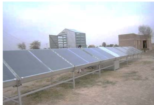
図 4.2.3 野菜・果物のソーラードライヤー
