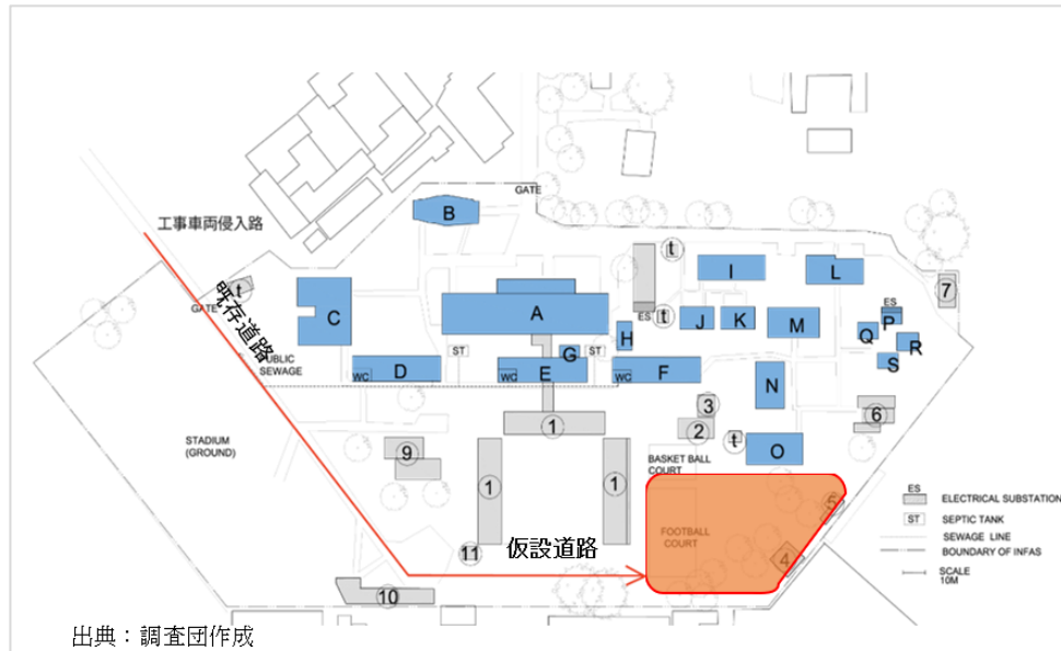
図 11：工事車両動線
