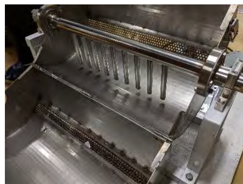
チャレンジ2の完成したプラスチック乾燥装置 (2021年、北九州高専)
