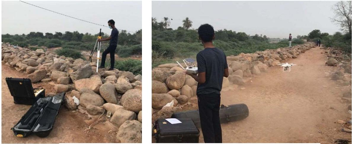
**Figure 2.1-6 Conditions de levé topographique (levé par drone)**
