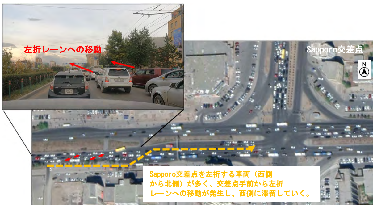
図 3.60 交差点左折車による滞留長の発生 (Sapporo 交差点の事例)
