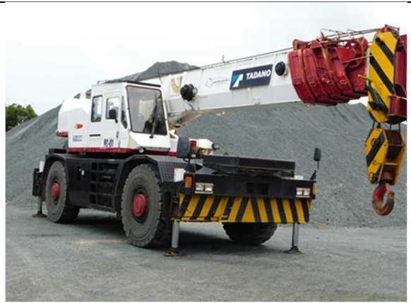
25t 吊ラフタークレーン
