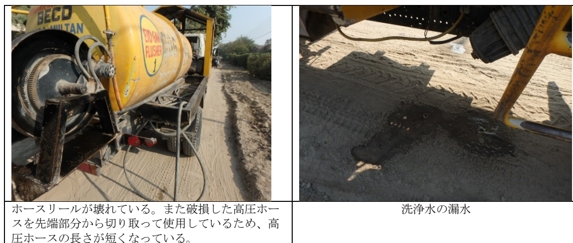
図 3.5-11 損傷が激しい高圧洗浄車
