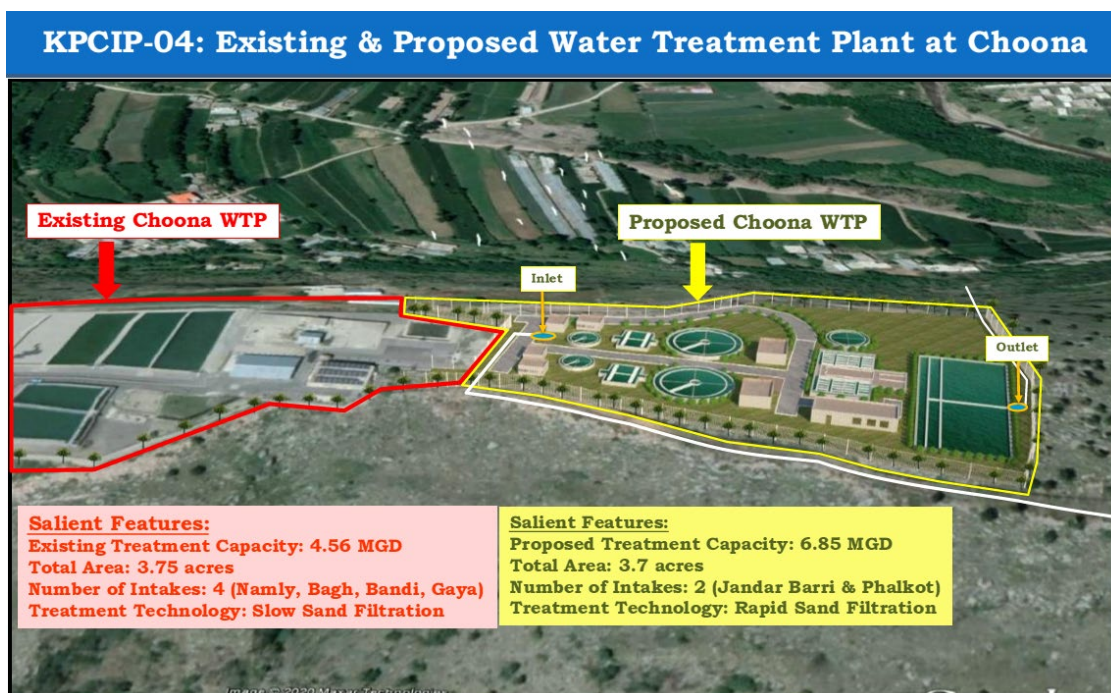
図 4.9-2 ADB 支援で既存浄水場の隣に建設される Choona 浄水場の配置図
