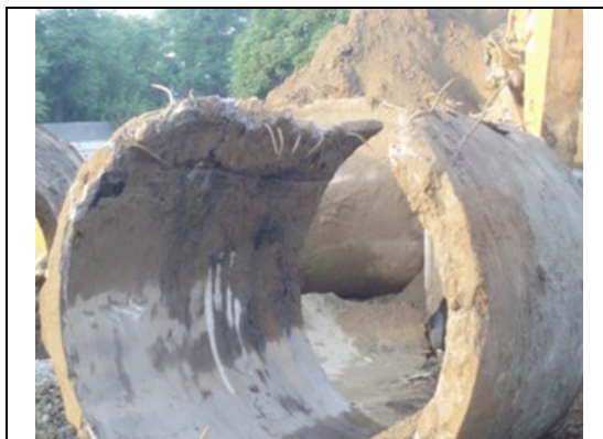
図 6.2-2 老朽化した鉄筋コンクリート管
