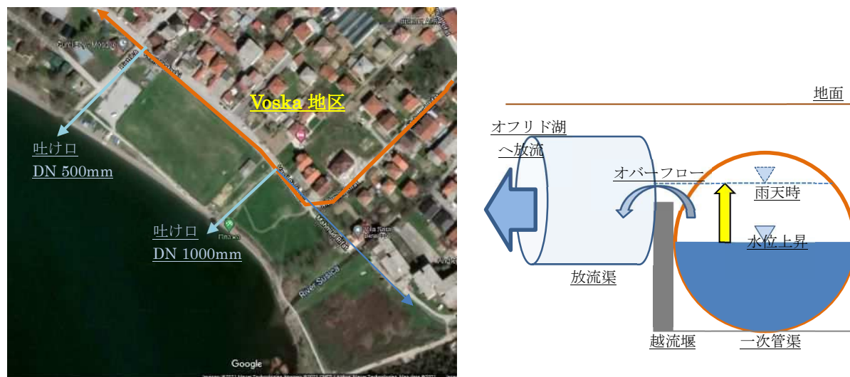
図 3.11 違法吐け口位置図と放流のメカニズム
