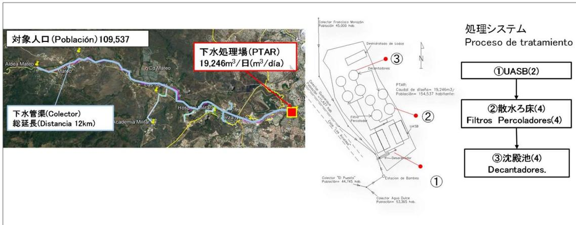
Figra 3-3-14 El esquema del plan de mejora del alcantarillado
