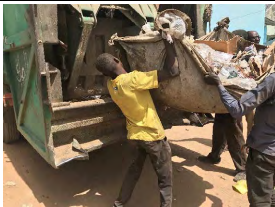
コンパクターへの積み込み 袋等の容器収集は行われておらず、散乱したごみを布に乗せて持ち上げ、コンパクターへ投入する。
