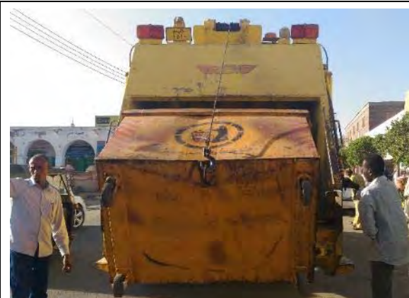
コンパクターによる収集（ポートスーダン郡） 道路脇に設置されたコンテナをウィンチで持ち 上げてごみを投入する。
