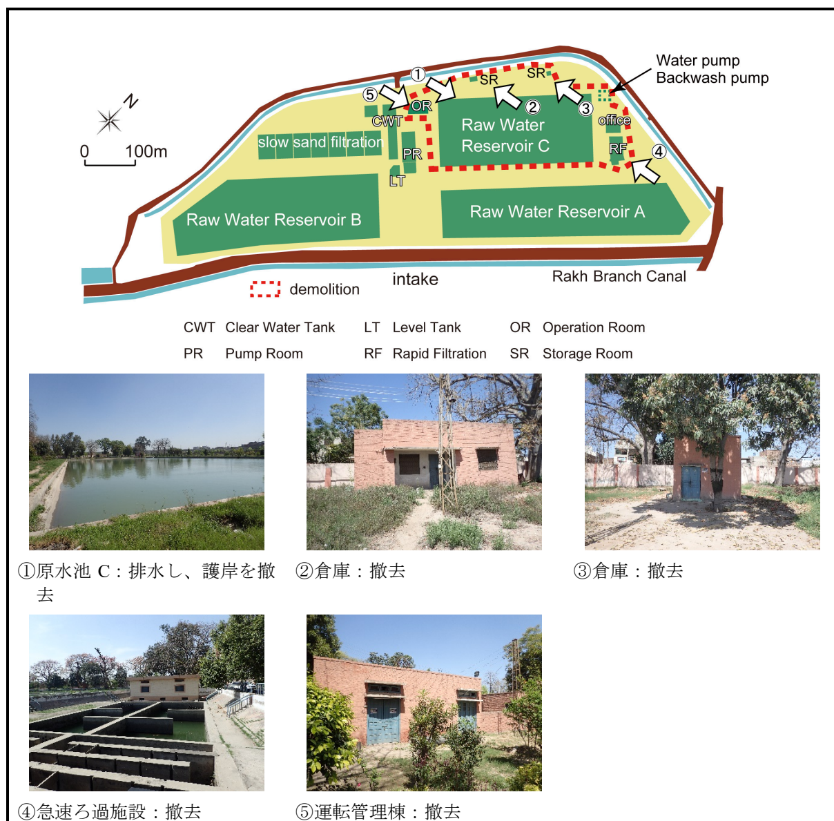
図 3-38 OJK 浄水場の撤去する既存施設
