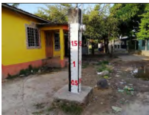
Sarmiento の民家に依頼し、コンクリート柱を塗装した
