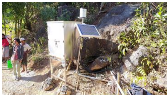
Kalaw 川中流に設置された自動採水器
