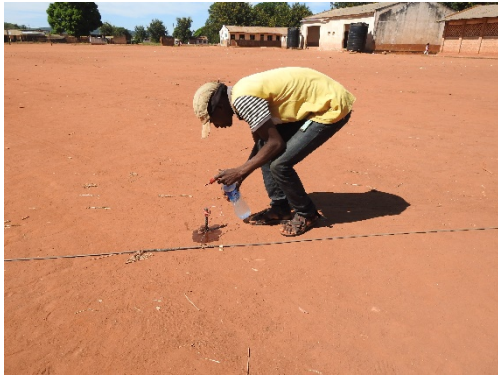
Auxiliar molhando o electrodo para melhorar o contacto solo-eletrodo (Malanga, Majune)
