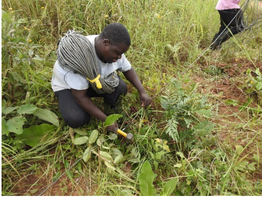
Instalação de electrodo (Mandimba)
