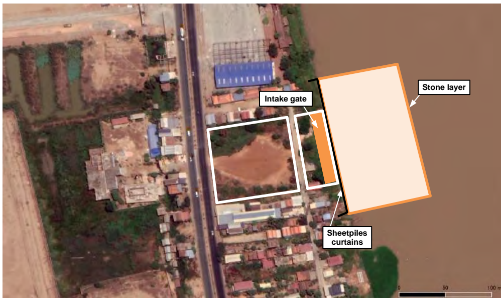
図 6-2.17 取水候補地点の護岸・河床保護の概略案 (平面、Ta Mouk)
