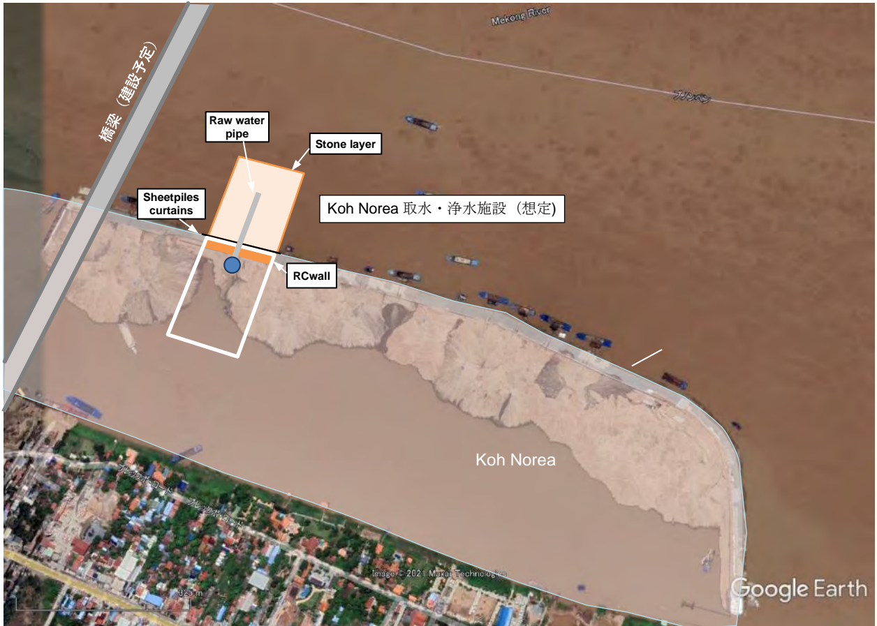
図 6-2.13 取水候補地点の護岸・河床保護の概略案（平面、Nirodh Phase III および Koh Norea）
