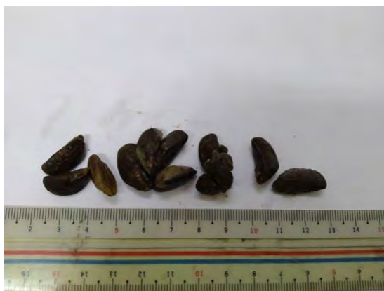
図 6-2.19 Nirodh 取水施設の堅坑内に固着していた貝類
