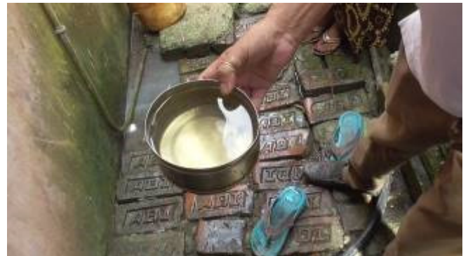
7-2 Pichara ポンプ場 (井戸の水に鉄とみられる色が出ている)
