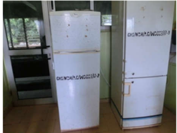
ビンビラ郡病院 一般の冷蔵庫を血液銀行冷蔵庫として10年以上継続使用している。
