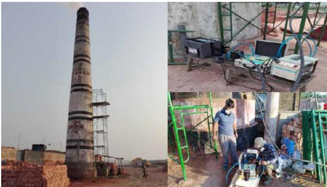
図 5.1-21 CASE プロジェクトにおけるレンガ窯の排ガスサンプリング状況
