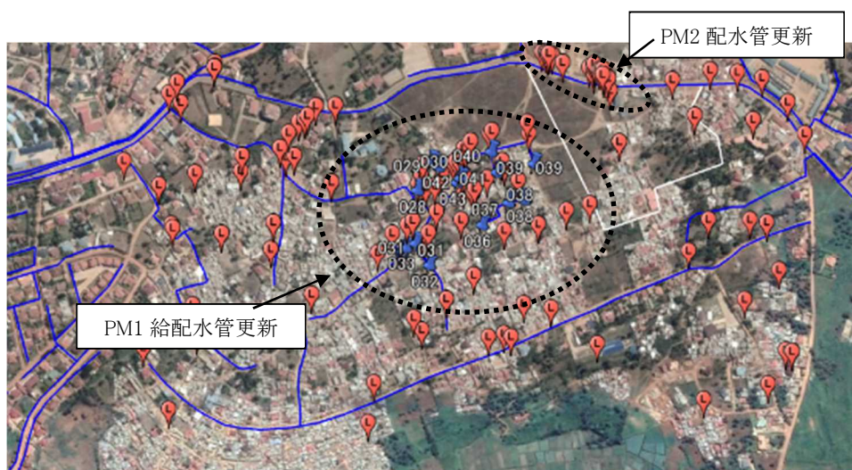
図 2.3 パイロットエリア 1(Kadobogo)における漏水修理位置のプロット(更新前)
